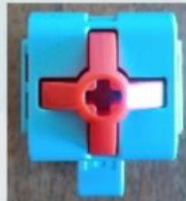
**Датчик цвета** - это цифровой датчик, который может определять цвет или яркость света, поступающего в небольшое окошко на лицевой стороне датчика.
