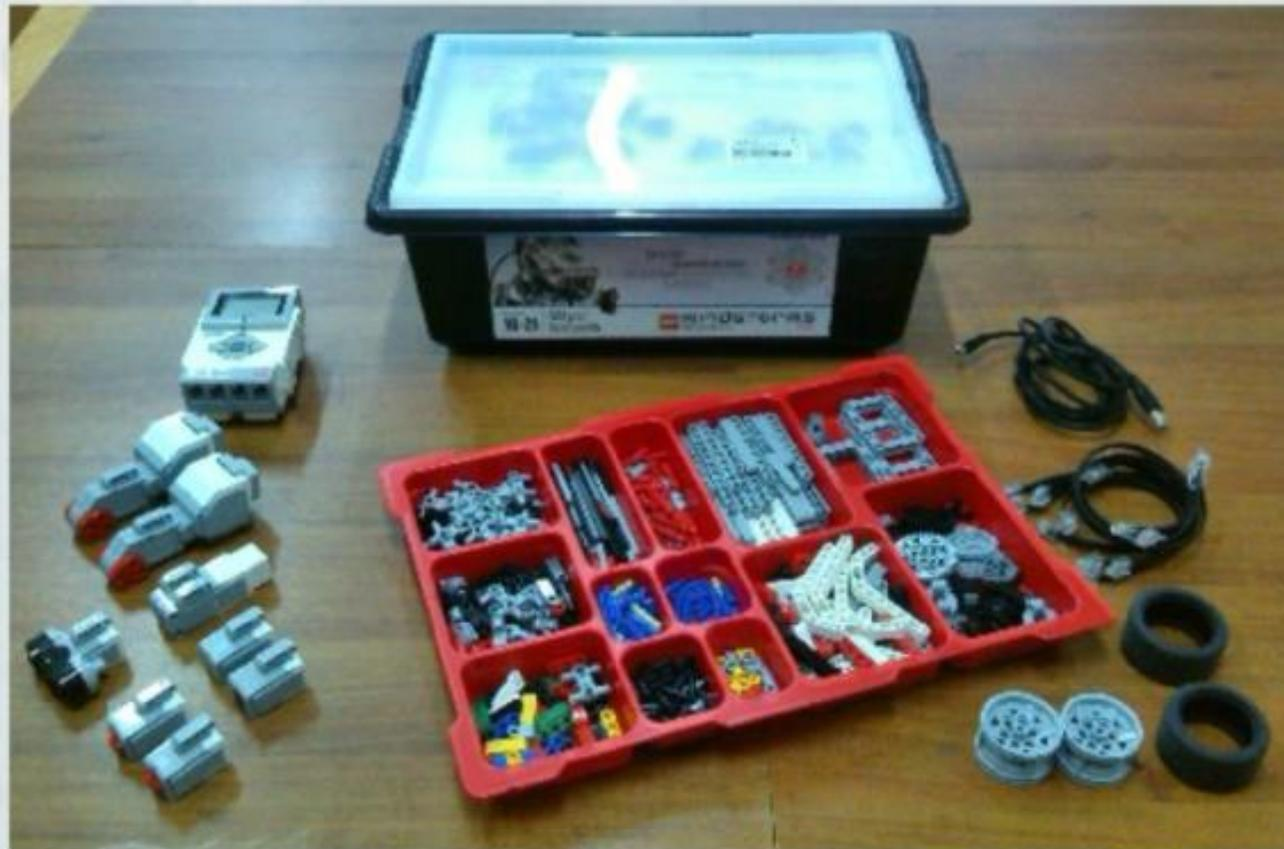
**Микрокомпьютер EV3** служит центром управления и энергетической станцией робота
